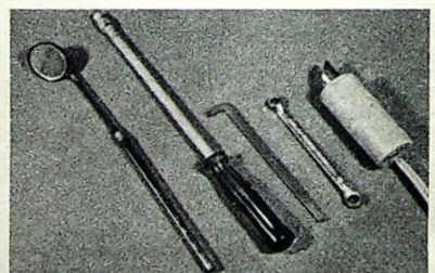
Spezialwerkzeuge und Zubehör für den Tonbandgeräte-Service (von links nach rechts: Mundspiegel, Steckschlüssel, Winkel-Schraubendreher, Schraubenschlüssel und Entmagnetisierungsdrossel)
